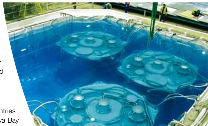
大亞灣近點實驗室純水池內的反中微子探測器，各為五米高、五米直徑。
