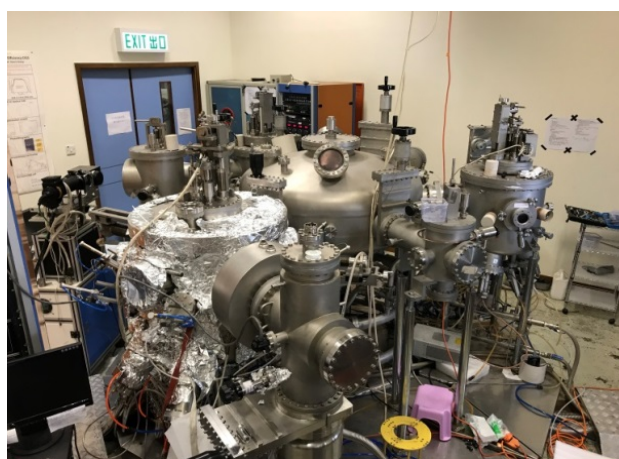
團隊設於香港中文大學物理系實驗室內之大型實驗儀器：CIGS Evaporation Chamber System (主題研究計劃資助了此儀器的部份零件，約六十萬港元)。
