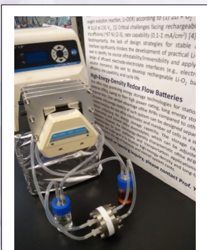
鋅-碘溴液流電池設計原型的外觀。 The zinc/iodine-bromide redox flow battery prototype.
