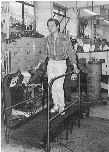
這部可調較快慢的跑步機可助病人復康，亦可測度病的跑步速度，是應矯形外科及創傷學系一位講師要求製造，耗時兩個月完成。
