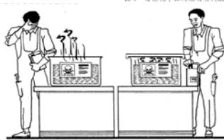
图 4 左图显示——敞开盖子的容器释放出有毒蒸气
