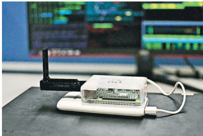
▲周斯明教授帶領的研究團隊發現很多企業級Wi-Fi無線網絡的用戶設定存在嚴重漏洞，導致黑客可利用如圖中的樹莓派（Raspberry Pi）裝置進行無線攻擊，偷取不同公司及大專院校的賬戶密碼。
