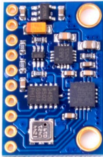
Figure 1: GY-801 IMU module
