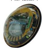
單輪機器人是一種全新概念的移動機器人。從外觀上看它只有一個輪子。裡面的飛輪不僅可以使機器人實現穩定運行,還可以控制機器人運動的方向。與其他多輪、靜態穩定的機器人相比,單輪機器人的優點在於:對外界的擾動不敏感,可操作性強,運動時的滾動摩擦力較低,可以從倒地的狀態中自動站立及水陸兩棲等。
