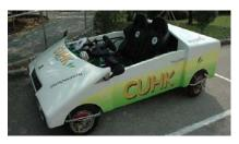
全方位轉向技術,包括四輪線控獨立驅動技術和四輪線 控獨立轉向技術。每一個驅動轉向輪組都包含一個驅動的輪 轂電機和一個轉向電機,因而可以配置成多種轉向模式,例 如:前輪轉向、四輪轉向、原地轉向、橫行移動等,增強車 輛的機動靈活性,便於在狹窄空間內的泊車。同時,去除了 傳統傳動軸和轉向機構,降低了車的重心,使得更穩定。
