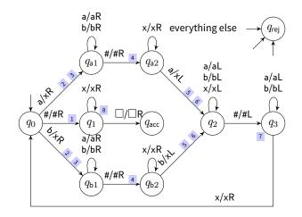
input: aab#aab configurations:  $q_0$  aab#aab x  $q_{a1}$  ab#aab xa  $q_{a1}$  b#aab xab  $q_{a1}$  #aab xab#  $q_{a2}$  aab xab  $q_2$  #xab xa  $q_3$  b#xab  $x q_3 ab#xab$  $q_3$  xab#xab x  $q_0$  ab#xab
