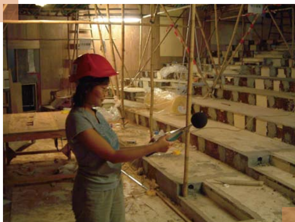
▲ USEO staff measuring the environmental noise level and occupational noise level of construction sites and renovation works. 大學安全及環境事務處職員到校內的建築工程地盤和施工場地，測量環境噪音水平和職業噪音水平。
