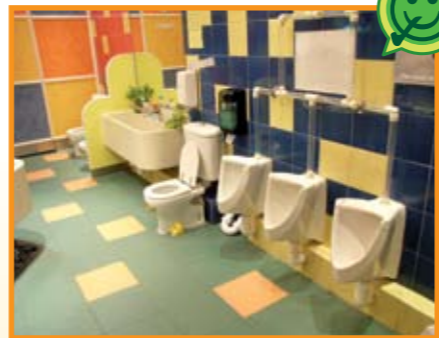
在洗手間應採用防滑地磚，而牆壁應鋪上至少1米高的瓷磚。
