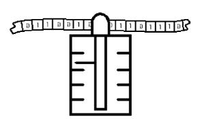
英國邏輯數學家圖靈(Alan Turing) 1936年提出了著名 的[圖靈機模型],包括三個核心部分:一條帶子、一個 讀寫頭、一個控制裝置。帶子分成許多小格,每小格儲 存一位數碼,以每次一格左右移動,讀寫頭受制於控制 裝置,可以讀小格內的數碼符號,或者在帶子上寫符 號。圖靈機可以把程式和資料都以數碼的形式存儲在帶 子上,即「存储程式」型,程式能把高階語言程式譯成機 器語言程式,這就是「通用圖靈機」原理。圖靈機模型並 不是製造具體機器的方案圖紙,而是提出了理想電腦原 理的邏輯構造,後來成為通用數位電腦的數學模型。
