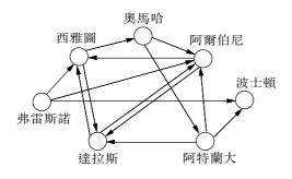
以飛機航線的選擇可以形象地説明哈密爾頓路徑問題。圖中每一個頂點代表一個機場,箭頭表示飛機從一個機場到另一個機場的方向。要求飛機從起點(設定弗雷斯諾機場)到終點(設定波士頓機場),必須經過圖中的每一個機場一次而且僅僅一次,確定符合這個要求的航線,用圖論的語言來說,就是確定「哈密爾頓路徑」。如果機場(頂點)的數量很少,可用窮盡搜索所有可能航線的方法求解。但頂點的數量如果增多,需要搜索的路徑會以指數級別增加,構成一個數學難題。
