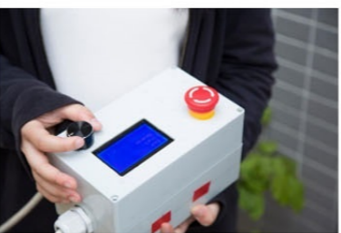
「生死制」是原設計以外的改良，防止刀片堵塞。
