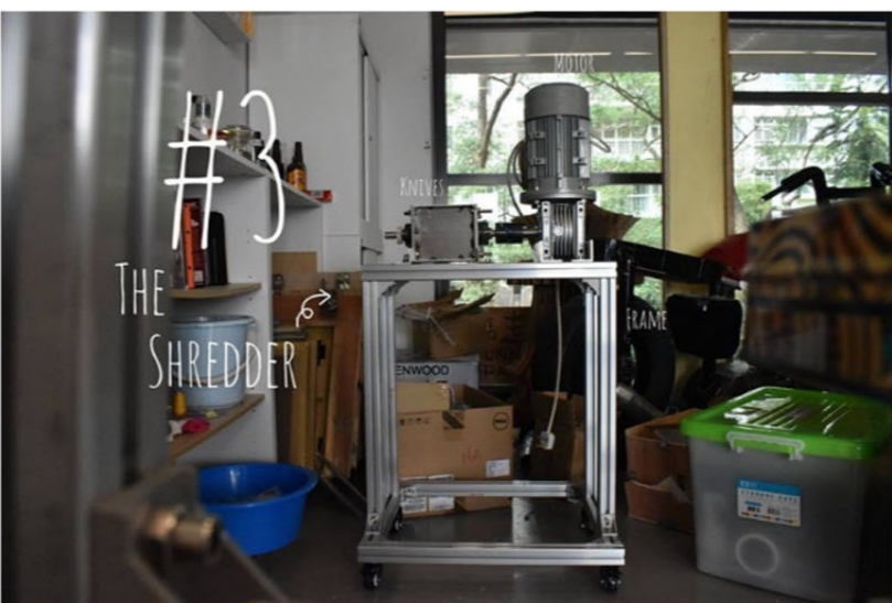
小組於2016年10月正式開始設計，現時碎膠機及熔膠機已經組裝完成。(Precious Plastic CUHK)
