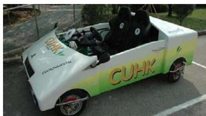
全方位轉向技術，包括四輪線控獨立驅動技術和四輪線控獨立轉向技術。每一個驅動轉向輪組都包含一個驅動的輪轂電機和一個轉向電機，因而可以配置成多種轉向模式，例如：前輪轉向、四輪轉向、原地轉向、橫行移動等，增強車輛的機動靈活性，便於在狹窄空間內的泊車。同時，去除了傳統傳動軸和轉向機構，降低了車的重心，使得更穩定。
