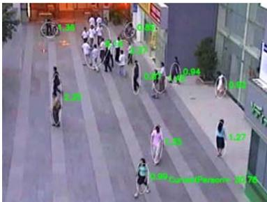
人數統計系統基於即時視頻處理和機器視覺技術，側重對監控區域內人數進行估計和統計。通過對人的行爲分析和識別，該系統能夠提供更準確及時的統計和分析信息，從而降低人工視頻監控的誤報漏報率，提升安全守衛工作的效率。根據監控區域，人數統計系統可分爲兩類，即重要場所出入口和公共場所。對前者進行人數統計、尾隨監測、和異常移動速度監測；對後者進行人群密度估計和人群異常行爲
