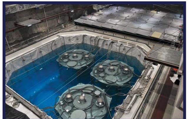
圖二：在首期實驗中，三個巨型探測器被放置在位於大「振盪」機率的實驗廳內，最後更會增至四個來采集更多的中微子數據。
