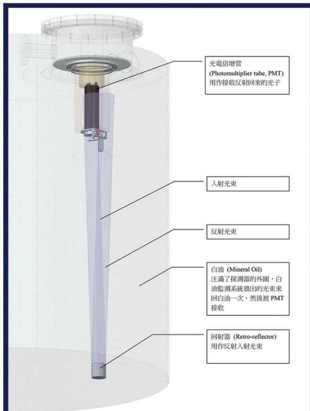
圖三：白油監察系統裝置圖。光源需要穿過白油，然後被反射鏡反射，沿路再穿過白油一次才回到感光的光電倍增管。反射鏡令光在白油之中行進的路程加倍，因而令白油對光的衰減效果也大大增加，變相提升監察系統的敏感度。
