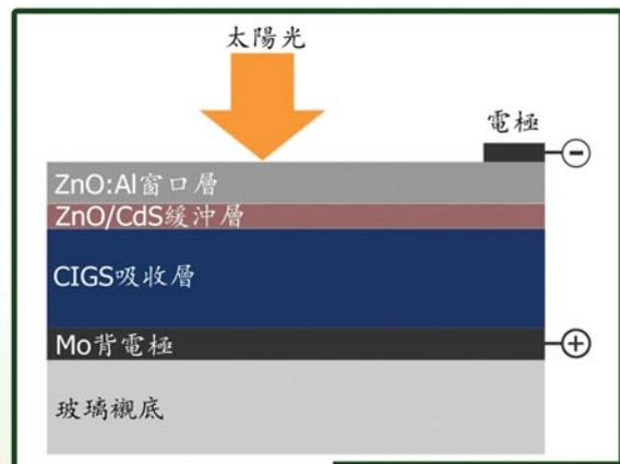
CIGS薄膜太陽能電池結構示意圖
